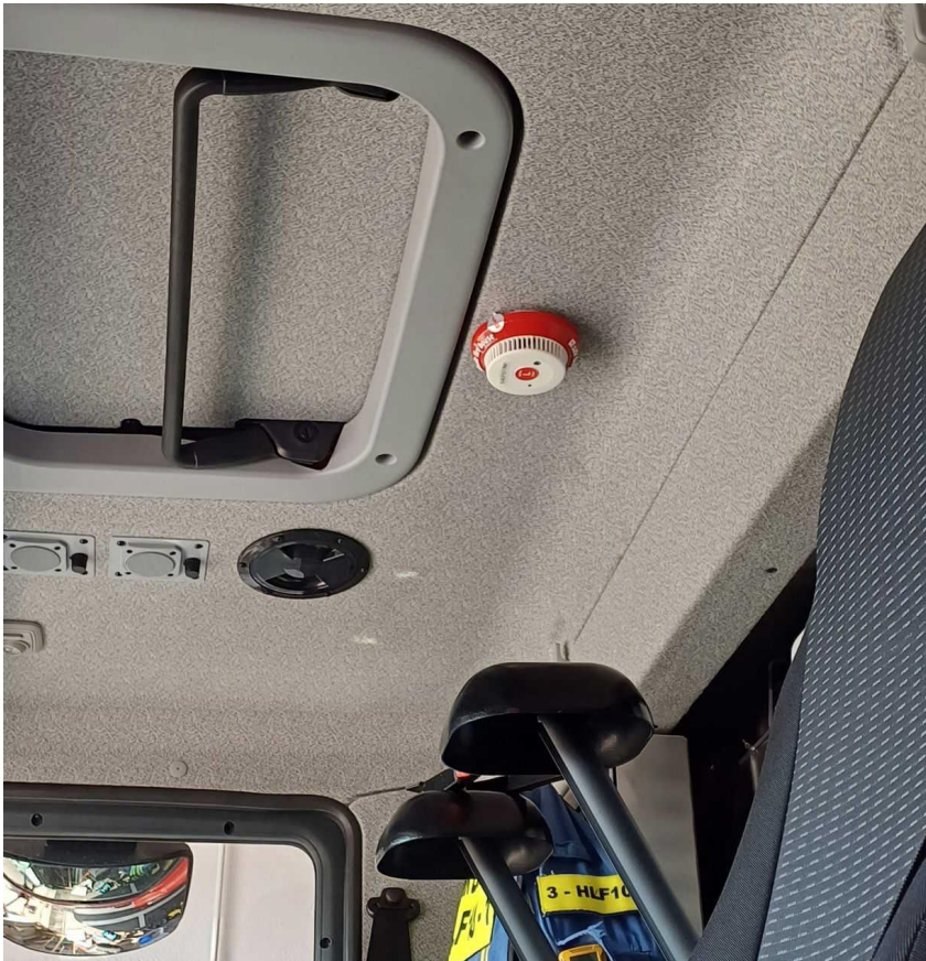
Sensor mittig in der Fahrerkabine
